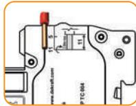
Качество монтажа достигается при условии правильного снятия изоляции. На корпусе аппарата нанесена специальная маркировка, которая позволяет легко и правильно снять изоляцию. Необходимо приложить провод к маркировке и снять изоляцию.
