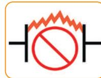
Самый надежный двойной разрыв цепи обеспечивается благодаря мостиковым контактам и полностью исключает возможность перекрытия дугой по изоляции, что может произойти, например, при использовании автоматического выключателя.
