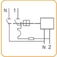
Размыкание обоих полюсов позволяет исключить возникновение опасных ситуаций при ошибочном монтаже
