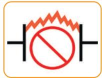
Самый надежный двойной разрыв цепи обеспечивается благодаря мостиковым контактам и полностью исключает возможность перекрытия дуги по изоляции, что может произойти, например, при использовании автоматического выключателя.
