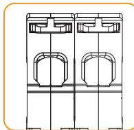
Номинальный ток до 50 А и возможность подключения кабелей сечением до 10 мм<sup>2</sup>.
