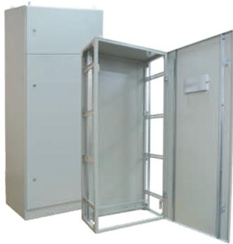
Корпуса ВРУ позволяют реализовать различные решения по щитовой сборке при создании систем распределения до 4000 А. Возможность соединения колонн в формате «спина к спине», «в линию», реализуется болтовыми соединениями в нескольких точках крепления, через специальные профили на каркасе.
