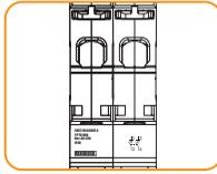
Номинальный ток до 125 А и возможность подключения кабелей сечением до 50 мм<sup>2</sup> делает возможным использовать ВН-105 в качестве общего пакетного выключателя.
