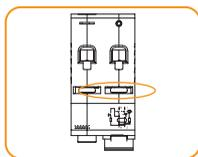
Система Bi-connect подключения входных и выходных клемм (возможность подключения аппаратов с помощью шины соединительной типа PIN и FORK).
