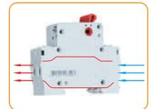
**Боковые каналы охлаждения** повышают технические характеристики и стабильность работы при высоких температурах окружающей среды. На боковой стороне аппарата указан максимальный крутящий момент клемм, и глубина зачистки проводника.
