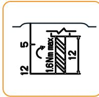
Качество монтажа достигается при условии правильного снятия изоляции. На корпусе аппарата нанесена специальная маркировка, которая позволяет легко и правильно снять изоляцию.
